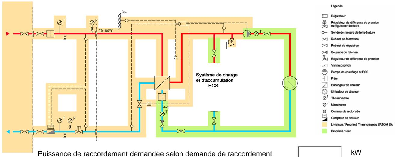
2) **Circuit secondaire :** système de charge et d'accumulation d'eau chaude sanitaire ECS
